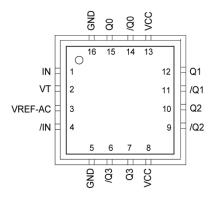
16-Pin QFN (QFN-16)
