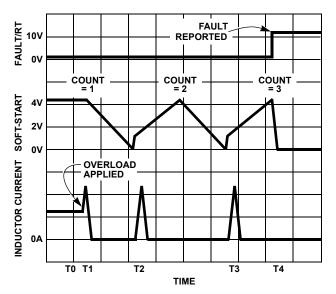
FIGURE 8. OVER-CURRENT OPERATION
