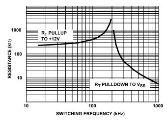
FIGURE 4. RT RESISTANCE vs FREQUENCY
