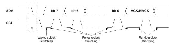
Figure 19-8. Clock stretching<sup>(1)</sup>.
