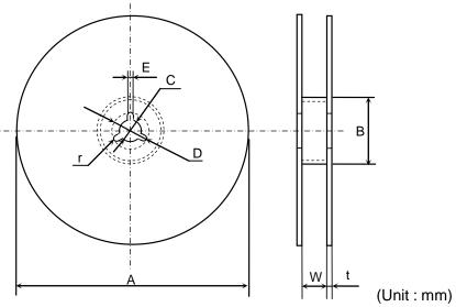
D Ε Symbol Α В С W Ø382 max. Dimension (Nominal Ø50 min.  $\emptyset$ 13 ± 0.5  $\emptyset$ 21 ± 0.8  $2.0 \pm 0.5$  $14.0 \pm 1.5$ Ø330)
