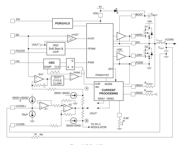
Figure 2. IC Block Diagram
