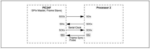
FIGURE 17-7: SPIX SLAVE, FRAME MASTER CONNECTION DIAGRAM
