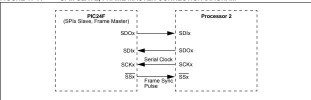
FIGURE 17-8: SPIX SLAVE, FRAME SLAVE CONNECTION DIAGRAM
