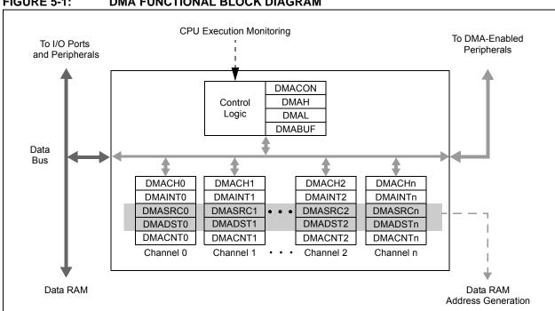
FIGURE 5-1: DMA FUNCTIONAL BLOCK DIAGRAM
