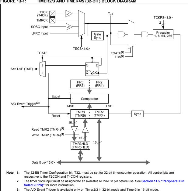
**FIGURE 13-1:** TIMER2/3 AND TIMER4/5 (32-BIT) BLOCK DIAGRAM
