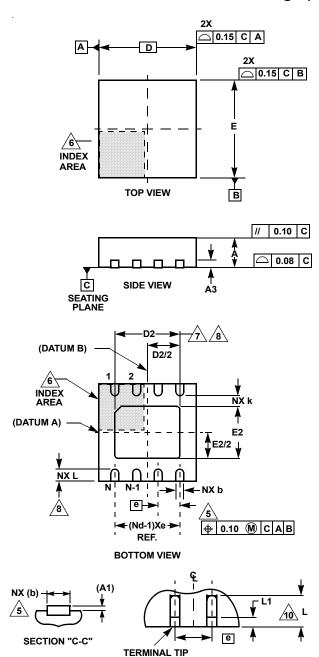
L8.3x3A 8 LEAD THIN DUAL FLAT NO-LEAD PLASTIC PACKAGE
