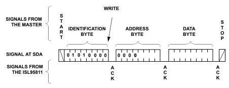
FIGURE 19. BYTE WRITE SEQUENCE
