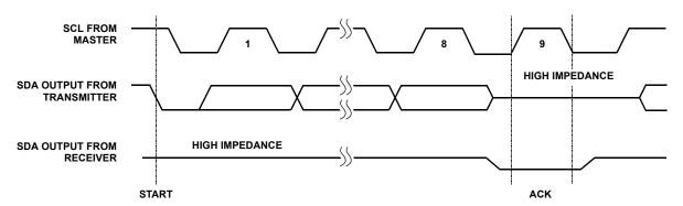
FIGURE 18. ACKNOWLEDGE RESPONSE FROM RECEIVER
