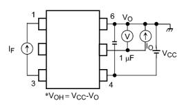
Fig. 12.1.3 V<sub>OH</sub> Test Circuit
