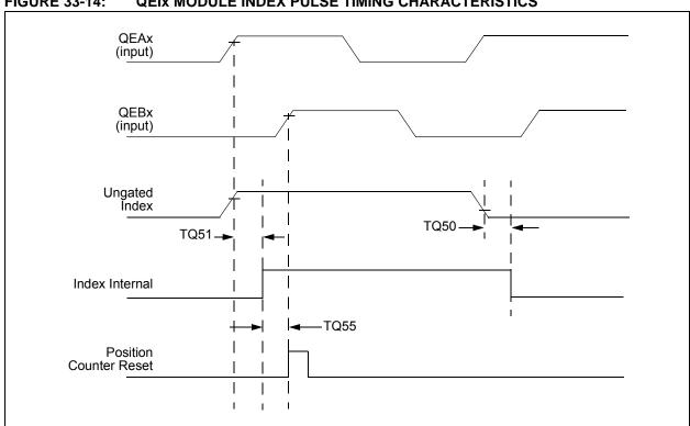
FIGURE 33-14: **QEIX MODULE INDEX PULSE TIMING CHARACTERISTICS**
