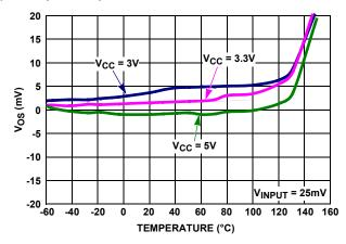
FIGURE 22. PRIMARY V<sub>BUS</sub> V<sub>OS</sub> vs TEMPERATURE
