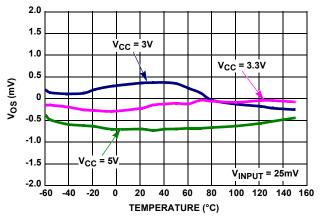
FIGURE 32. AUXILIARY V<sub>BUS</sub> VOS vs TEMPERATURE
