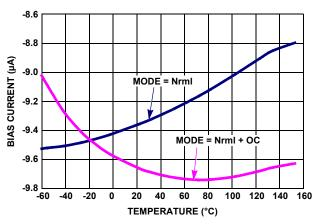
FIGURE 41. PRIMARY V<sub>SHUNT</sub> BIAS CURRENT vs TEMPERATURE
