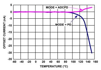
FIGURE 44. PRIMARY V<sub>SHUNT</sub> BIAS CURRENT OFFSET vs TEMPERATURE (POWER-DOWN MODE)
