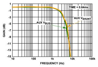
FIGURE 28. AUXILIARY V<sub>SHUNT</sub> AND V<sub>BUS</sub> vs FREQUENCY
