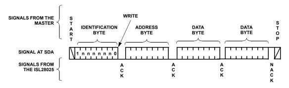
FIGURE 72. BYTE WRITE SEQUENCE (SLAVE ADDRESS INDICATED BY nnnn)
