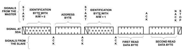
FIGURE 73. READ SEQUENCE (SLAVE ADDRESS SHOWN AS nnnn)
