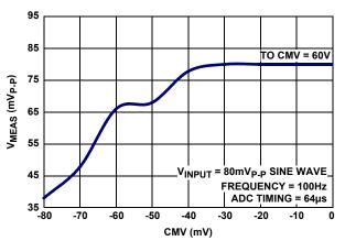
FIGURE 11. PRIMARY V<sub>SHUNT</sub> COMMON-MODE RANGE
