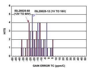
FIGURE 24. PRIMARY V<sub>BUS</sub> ADC GAIN ERROR TC
