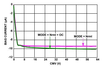
FIGURE 45. PRIMARY V<sub>SHUNT</sub> BIAS CURRENT vs COMMON-MODE VOLTAGE
