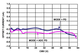
FIGURE 48. PRIMARY V<sub>SHUNT</sub> OFFSET CURRENT vs COMMON-MODE **VOLTAGE (POWER DOWN MODES)**
