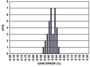
FIGURE 13. PRIMARY V<sub>SHUNT</sub> ADC GAIN ERROR
