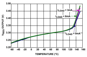
FIGURE 50. V<sub>REG</sub> OUTPUT vs TEMPERATURE
