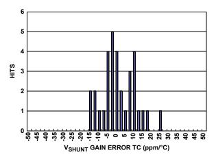
FIGURE 14. PRIMARY V<sub>SHUNT</sub> ADC GAIN ERROR TC
