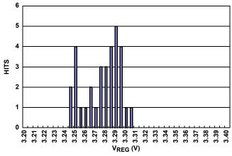
FIGURE 49. VREG OUTPUT VOLTAGE DISTRIBUTION
