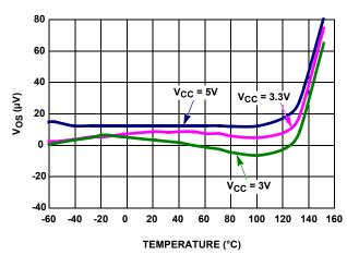
FIGURE 6. PRIMARY V<sub>SHUNT</sub> V<sub>OS</sub> vs TEMPERATURE
