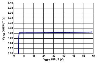
FIGURE 51. V<sub>REG</sub> OUTPUT vs INPUT VOLTAGE
