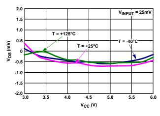
FIGURE 30. AUXILIARY  $V_{BUS}$   $V_{OS}$  vs  $V_{CC}$
