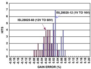
FIGURE 23. PRIMARY V<sub>BUS</sub> ADC GAIN ERROR
