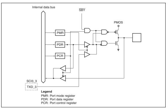
Figure B.10 Port 5 Block Diagram (P57) (H8/36024)
