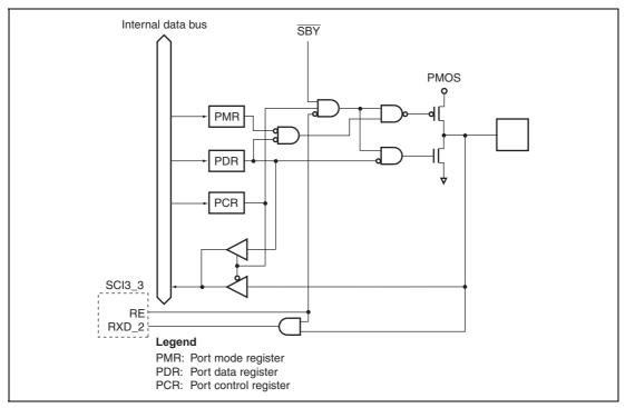
Figure B.11 Port 5 Block Diagram (P56) (H8/36024)
