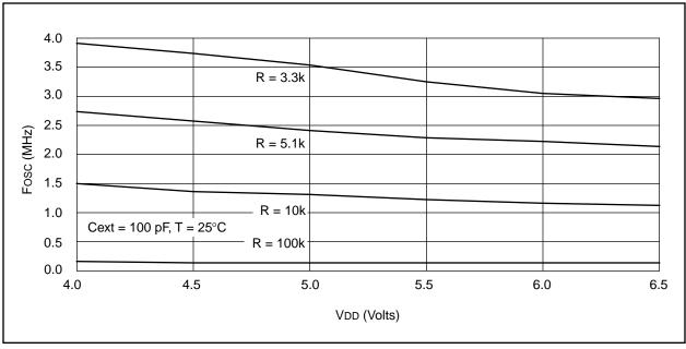
FIGURE 20-4: TYPICAL RC OSCILLATOR FREQUENCY vs. VDD
