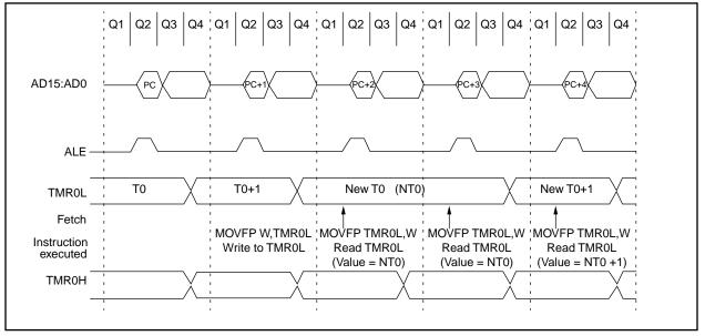
FIGURE 11-5: TMR0 READ/WRITE IN TIMER MODE
