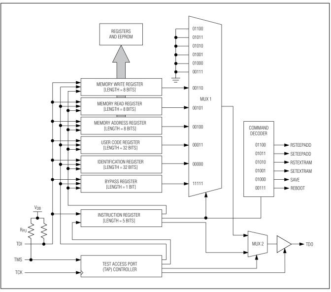
Figure 13. JTAG Block Diagram
