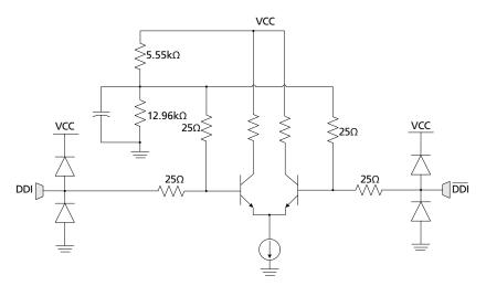
Figure 3-1: High-speed Inputs (DDI0, DDI0, DDI1, DDI1, DDI2, DDI2, DDI3, DDI3)
