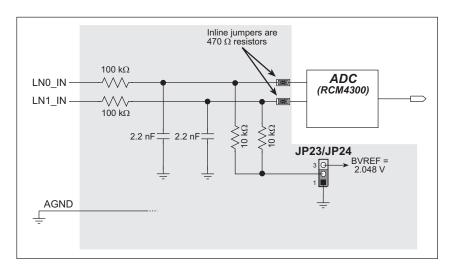
Figure B-6. A/D Converter Inputs
